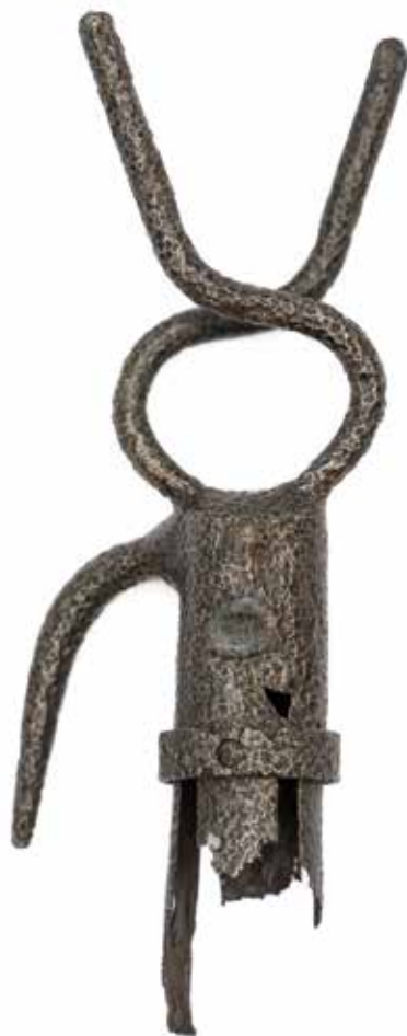
Rososzka (do rozciągania linii telefonicznej), nr inw. MT/920/H Rososhka/Rososzka (device for stretching the telephone line), Acc. No. MT/920/H
